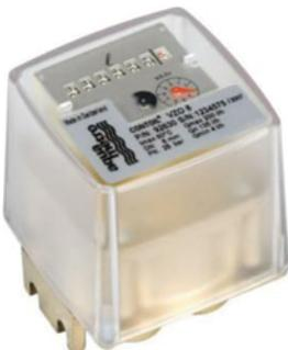
Имеют волюметрическим принцип измерения, основанный на измерении количества оборотов ротора, выполненного в виде колбы, вращающейся под действием потока жидкого топлива. Количество оборотов ротора пропорционально объёму топлива, прошедшему через расходомер. Вращательное движение ротора передаётся на механический сумматор. В механическом сумматоре значение объёма жидкости индицируются на роликовом счётном устройстве (циферблете).
